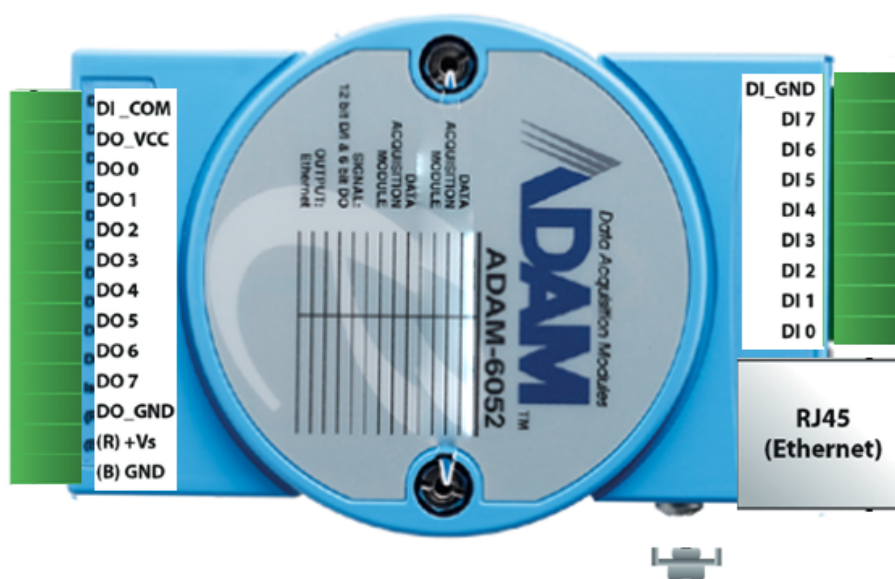
Рис. 9 Назначение контактов модуля ADAM-6052
