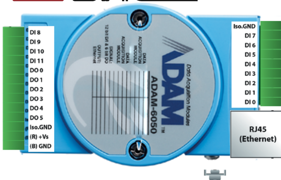
Рис. 8 Назначение контактов модуля ADAM-6050
